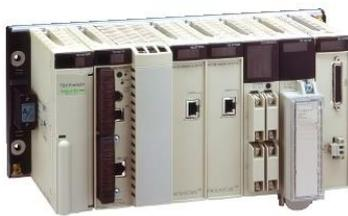
Les automatismes du filtre-presse sont actuellement assurés par un PLC Schneider Modicon Premium obsolète, il faut donc le remplacer par un PLC Modicon M340. Cette machine est également commandée par un terminal Schneider Magelis plutôt désuet, donc le remplacement d'automate donne l'occasion de le changer pour un HMI X2 Base de Beijer Electronics. Dans la foulée, ce projet de retrofit permet d'analyser le programme existant et d'en créer une version améliorée.
